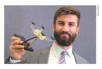
Den Prototyp eines neuartigen Saug-Greifers für flache Werkstücke hat Ingenieur Paul Motzki mitentwickelt.
