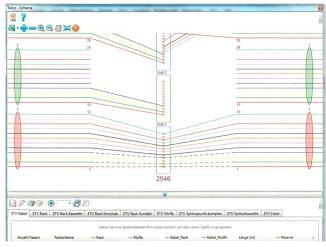
Bild 2: Ausschnitt eines Schemas mit Muffe inkl. Fasern, Kassette und Spleisspunkten.
