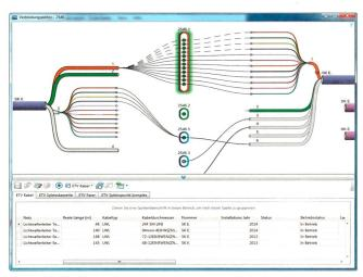
Bild 3: Verbindungseditor; Verknüpfen von Fasern in einer Muffe mit Kassetten. Geplante Fasern werden gestrichelt dargestellt.
