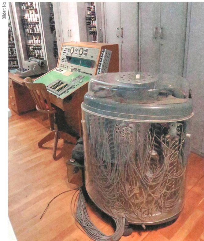
Bild 2 Der Ermeth-Arbeitsspeicher war ein Magnettrommel-speicher (vorne) mit 250 Magnetköpfen, die nur 10 µm von der Trommel entfernt waren. Die Trommel drehte sich mit 100 Umdrehungen pro Sekunde.
