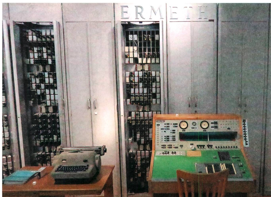
Bild 1 Die elektronische Rechenmaschine der ETH, Ermeth, ist nun im Museum für Kommunikation, Bern, ausgestellt. Die zehn Röhrenschränke sind mit insgesamt 1900 Elektronenröhren ausgerüstet, deren Kühlung eine Herausforderung darstellte. Die Schreibmaschine diente dem «Abtippen» der Resultate und stellte somit das Ausgabegerät dar.
