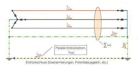
Bild 2 Entstehung von Summenströmen im Netzsystem TN-C.
