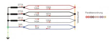
Bild 6 Ungleiche Verteilung der Transformatorenströme auf die Doppelleitungen.
