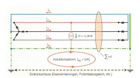
**Bild 3** Koppelspannung zwischen L₁ und PE im Netzsystem TN-S.
