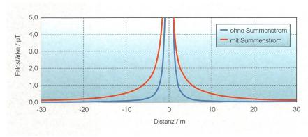
**Bild 4** Verlauf des magnetischen Feldes. I<sub>L1</sub>=450 A, I<sub>L2</sub>=390 A, I<sub>L3</sub>=425 A, I<sub>N</sub>=52 A; Summenstrom=30 A.
