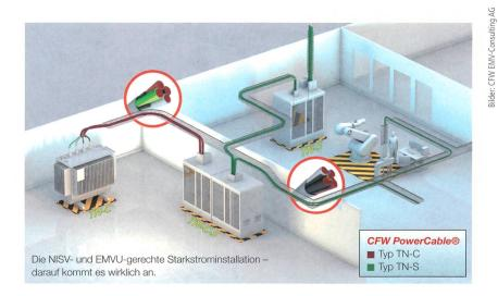
**Bild 8** Ausführung einer NISV- bzw. EMVU-gerechten Starkstrominstallation.
