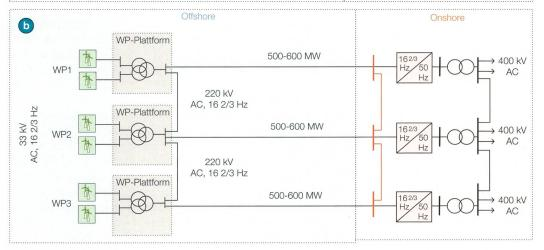
**Bild 2** Prinzip der Energieübertragung von Windparks (WP): a) Gleichstrom; b)16,7-Hz-Drehstrom (rote Vermaschung nur hier möglich).
