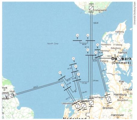
Bild 3 Hypothetisches Nordsee-Verbundnetz 3 AC 220 kV 16,7 Hz, Trassenlängen in km.
