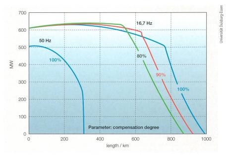
**Bild 1** Wirkleistungs-Übertragungsvermögen Unterwasserkabel 3 x 1200 mm² Cu/RM bei 3 AC 245 kV Eingangsspannung.
