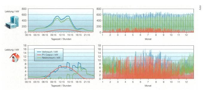
Bild 2 Stromverbrauch und PV-Stromproduktion im Verlauf eines Tages (links) und eines Jahres (rechts) für Bürogebäude (oben) und Privatgebäude (unten).
