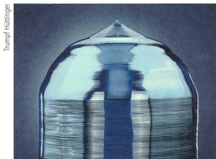
Abschmelzstelle eines Silizium-Einkristallstabs, der mit dem Zonenschmelzverfahren hergestellt wurde.
