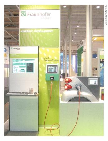
**Bild 2** Die in Softund Hardware abgebildete Ladeinfrastruktur des Fraunhofer ESK kann als Gegenstelle zum Test neuer Produkte auf Standardkonformität dienen.
