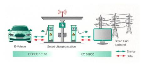
**Bild 1** Das Fraunhofer ESK hat mit der Implementierung der internationalen Standards ISO/ IEC 15118 und IEC 61850 die Kommunikationsschnittstellen für eine intelligente Ladeinfrastruktur für E-Fahrzeuge realisiert.
