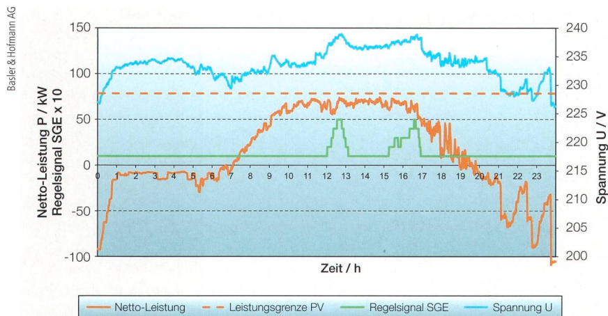
Bild 4 Netzspannung und Regelsignal am Beispiel eines Tagesablaufs ohne aktive Regelung.
