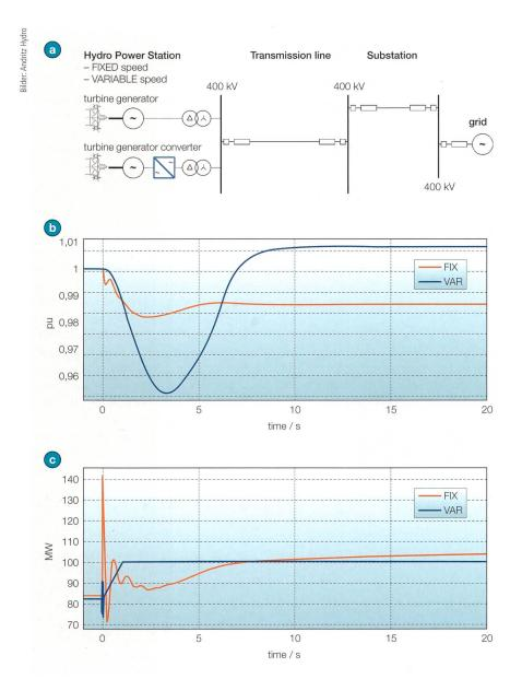
**Bild 5** Oben: Übersicht über das System Wasserkraftwerk – elektrisches Netz; Mitte/unten: Simulationsergebnisse für fixe Drehzahl (rot) und variable Drehzahl (blau).
