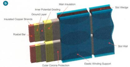
**Bild 4** Temperaturverlauf in den einzelnen Komponenten der HV-Isolation der Statorwicklung (oben), Aufbau der HV-Isolation (unten).
