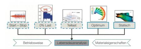
**Bild 2** Berechnungsmethodik für die Lebensdaueranalyse eines Turbinenlaufrades für unterschiedliche Betriebsbereiche: Start-Stopp, 0 % Last bis Teillast: stochastische Ansätze, über 50 % Last harmonische Analyse.
