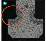
**Bild 3** Polbleche einer bestehenden Anlage (links) und FEM-Modell einer Modifikation zur Reduktion der Spannungen (rechts).
