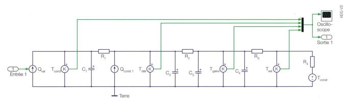
Figure 3 Circuit équivalent d'un câble monophasé basse tension (sans le sol).
