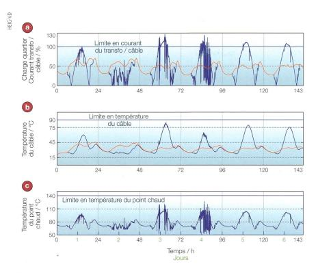
**Figure 4** Allures des puissances (a), ainsi que des températures du câble (b) et du point chaud du transformateur (c), avant (en rouge) et après (en bleu) l'implémentation de la centrale photovoltaïque.
