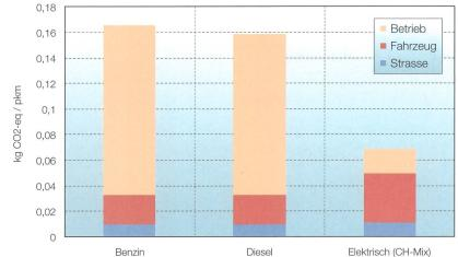
**Bild 2** Vergleich der Treibhausgasemissionen über den gesamten Lebenszyklus bei einem Benzin, einem Diesel (beide Euro 5) und einem elektrischen PKW.
