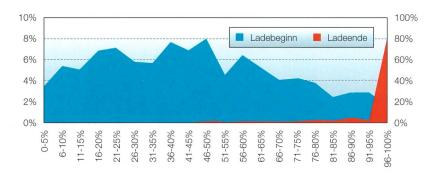
**Bild 1** Batterieladezustand in Prozent bei Ladebeginn und Ladeende von knapp 4000 erfassten Ladevorgängen. 20 % aller Ladungen begannen bei einem Batterieladezustand von weniger als 20 %. Diese Fahrer nutzten die Batteriekapazität weitgehend aus.
