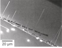
Fabrication de nanopoils: différents métaux (par exemple le palladium ou l'or) sont déposés par évaporation sous vide sur un substrat.
