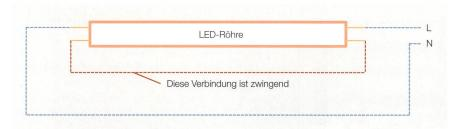
Bild 3 Richtig: Schema muss bei einer Umverdrahtung befolgt werden. Andere Arten von Verdrahtungen sind in der Schweiz verboten.
