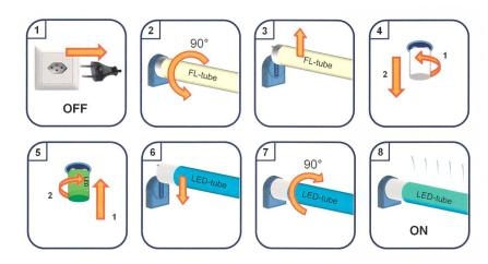
Figure 1 Instructions pour un remplacement sûr (IEC 62776).
