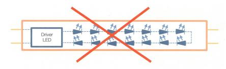
**Figure 4** Faux : cette configuration est interdite en Suisse. Une connexion intérieure des extrémités vides est une obligation. Dans le cas contraire, le tube LED ne peut pas être utilisé comme remplacement dans une armature avec ballast électromagnétique conventionnel.
