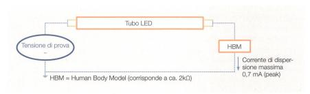
Figura 2 Schema misurazione corrente di dispersione.
