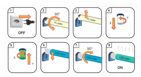
Figura 1 Istruzioni per una sostituzione sicura (IEC 62776).
