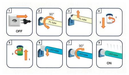
Bild 1 Anleitung für den sicheren Austausch (IEC 62776).
