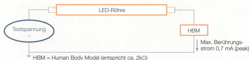
Bild 2 Schema Messung Berührungsstrom.
