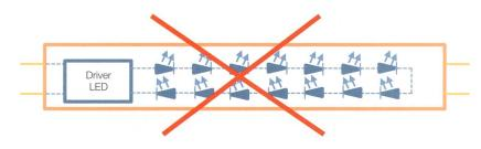
**Figura 4** Errato: in Svizzera questa configurazione è vietata. È obbligatorio il collegamento interno delle estremità libere, altrimenti il tubo LED non può essere utilizzato come soluzione retrofit in un'armatura con alimentatore elettromagnetico convenzionale.
