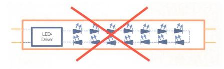
**Bild 4** Falsch: Diese Konfiguration ist in der Schweiz verboten. Eine innere Verbindung der leeren Anschlussenden ist Pflicht, sonst kann die LED-Röhre nicht als Retrofit-Lösung für eine Armatur mit KVG verwendet werden.
