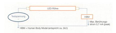
Bild 2 Schema Messung Berührungsstrom.
