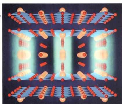
Die resonante Anregung von Sauerstoff-Schwingungen (unscharf) zwischen Kupferdioxid-Dopantschichten ermöglicht die Supraleitung.
