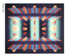
Die resonante Anregung von Sauerstoff-Schwingungen (unscharf) zwischen Kupferdioxid-Doppelschichten ermöglicht die Supraleitung.
