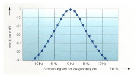
Bild 6 Filtercharakteristik CPC 100.
