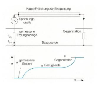
**Bild 1** Prinzip des Messaufbaus und des Potenzialverlaufs.
