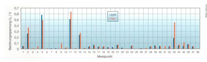
Bild 15 Bezogene Berührungsspannung verschiedener Messpunkte bei Vergleichsmessung 3a.
