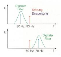
**Bild 5** Störgrössenelimination der frequenzselektiven Methode.
