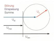
**Bild 4** Diagramm zur Veranschaulichung der Schwebungsmethode.
