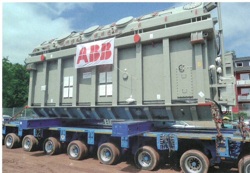
Bild 3 Transport eines Transformators mit einem Leergewicht von 190 t von Bad Honnef bei Bonn ins Glarnerland.
