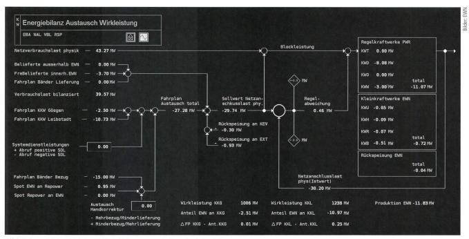
Bild 6 Energiebilanzbild der EWN-Subbilanzgruppe in Regelkreisdarstellung.
