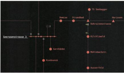
**Bild 5** Ausschnitt aus dem 30-kV-Netzbild mit eingefärbter Netztopologie.
