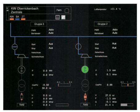
**Bild 4** Zentralenbild zum Kraftwerk Oberrickenbach (Ausschnitt).
