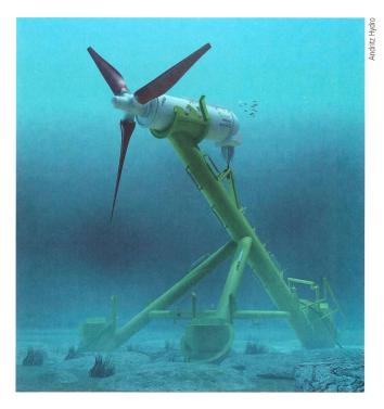
Bild 1 Eine im European Marine Energy Centre getestete Gezeitenturbine mit einer Leistung über 1 MW und einem Rotordurchmesser von 21 m.
