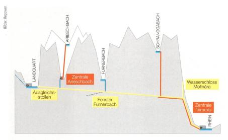
**Bild 4** Schematisches Längsprofil des Kraftwerks Chlus zwischen Küblis (links) und dem Zentralenstandort Trimmis (rechts). In der Anlage wird Wasser aus der Landquart sowie der drei Seitenbäche Arieschbach, Furnerbach und Schranggabach turbiniert.
