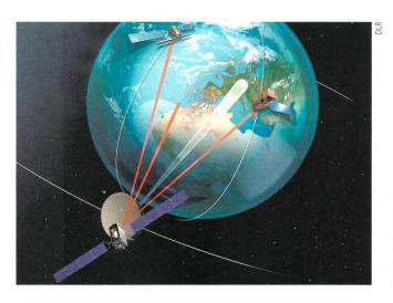
«Super-Laser» revolutioniert Übertragung im All: Alphasat und Sentinel 1A tauschen Daten per LCT aus.
