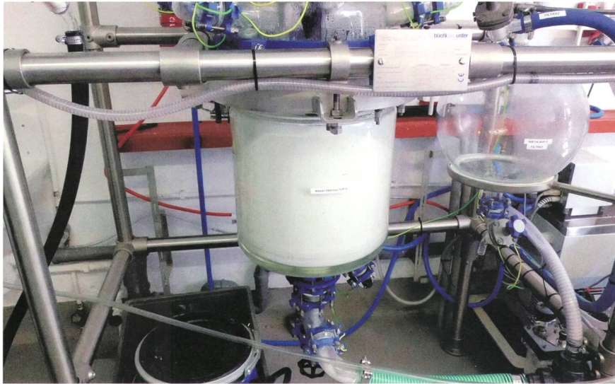
Réacteur chimique contenant des déchets de substances luminescentes et le fluide lixiviant.
