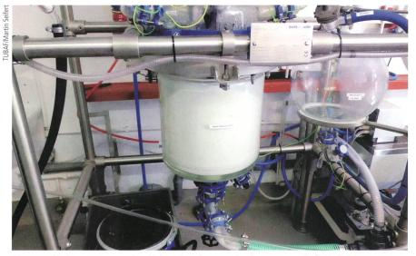
Réacteur chimique contenant des déchets de substances luminescentes et le fluide lixiviant.
