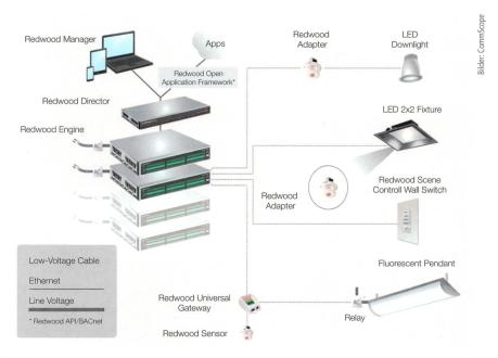
Bild 3 Schema einer UKV-Lichtlösung.
