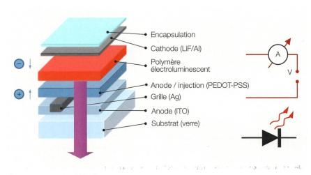
Figure 1 Coupe simplifiée d'une OLED.
