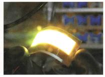
Figure 5 OLED réalisée sur un substrat flexible Sefar (10 x 10 cm<sup>2</sup>, 3500 cd/m<sup>2</sup>, 12 cd/A, 10 V).
