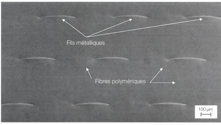
**Figure 4** Image au microscope électronique d'un tissu incorporant des fils métalliques. Le diamètre de ces fils est de l'ordre de 20 µm.
