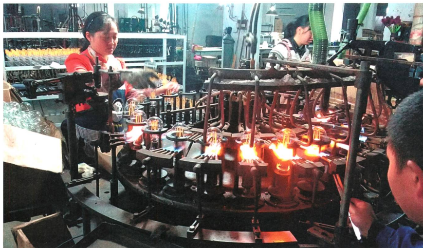
Bild 4 Glas-Montage auf Rotationsautomat (Verschmelzung).
