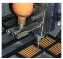
**Bild 3** Phosphor-Beschichtung der Saphir-Glas-Filamente
