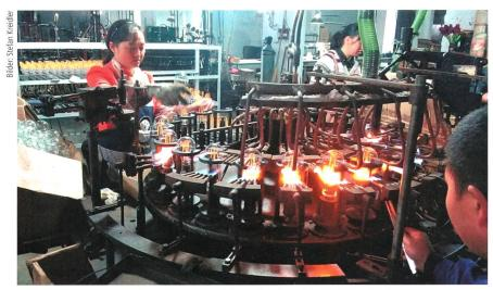
**Bild 4** Glas-Montage auf Rotationsautomat (Verschmelzung).
