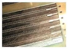
**Bild 2** Glas-Filamente mit LEDs bestückt und verbondet (ohne Phosphor).
