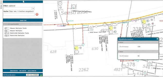
Bild 2 Beispiel einer Detailansicht: Rohrverfolgung und Trassenguerschnitt.
