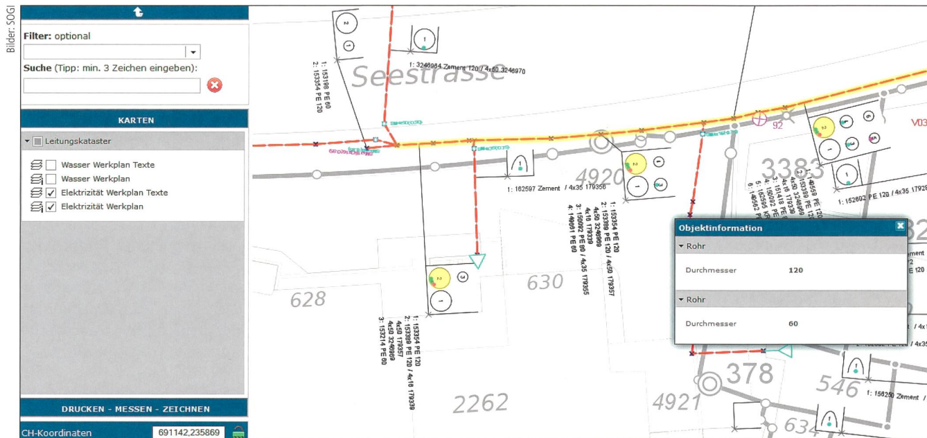
Bild 2 Beispiel einer Detailansicht: Rohrverfolgung und Trassenquerschnitt.
