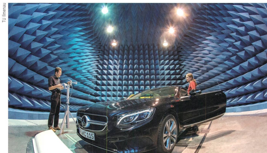
Abschirmhalle zur Nachbildung einer virtuellen elektromagnetischen Umgebung.
