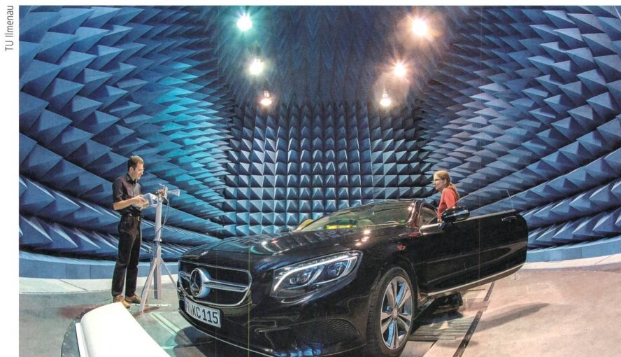
Abschirmhalle zur Nachbildung einer virtuellen elektromagnetischen Umgebung.
