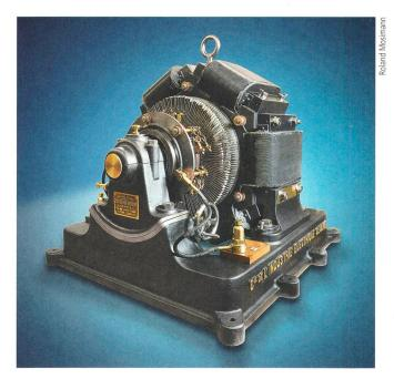
**Bild 1** Gleichstrommaschine von René Thury (CIE, Genf 1897).
