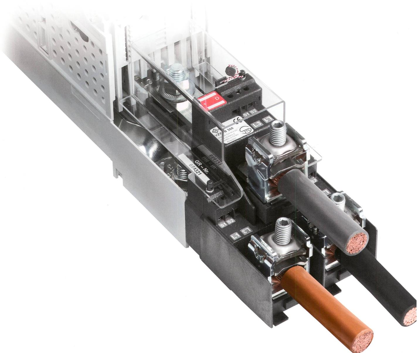
Der 3-polige Stromwandlerblock mit Klasse 0,5 s ist eichfähig und erfüllt sämtliche Anforderungen der EVU-Messung. Der Stromwandler kann ohne andere Anlagenteile zu entfernen an eine weber.vertigroup Gr. 1-3 montiert oder ausgewechselt werden – auch nachträglich! Klickbare Kabelhalter schützen die verlegten Kabel. Die Anschlüsse für die Spannungsabnahme sind am Ein- oder Abgang des Standardgeräts vorbereitet.
