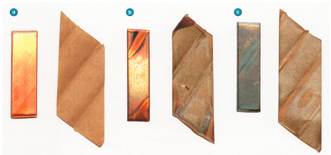
Bild 2 Beispiele von Testergebnissen gemäss IEC 62535: Kupfersulfidablagerung auf Test-Kupferstreifen und Papierisolation: a) keine Ablagerung, b) leichte Ablagerungen, c) starke Ablagerungen
