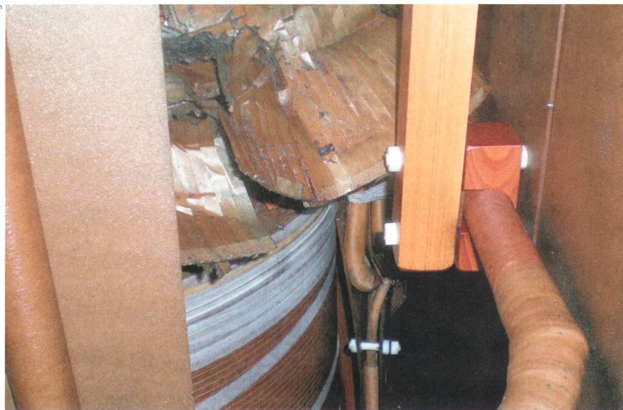
Bild 3 Transformator mit deutlichen Kupfersulfidablagerungen auf der Feststoffisolation.
