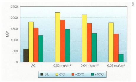
**Bild 3** Thermische Belastbarkeit und natürliche Leistung (SIL = Surge Impedance Loading) einer 380-kV-AC-Leitung sowie thermische Belastbarkeit einer  $\pm 400$ -kV-DC-Leitung für verschiedene Isolator-Verschmutzungsgrade in Abhängigkeit der Umgebungstemperatur.
