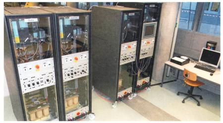
Figure 4 Maquette du réseau multiterminal DC au laboratoire : vue d'ensemble.
