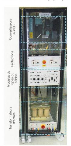
**Figure 5** Détail d'une armoire de la maquette du réseau multiterminal DC.
