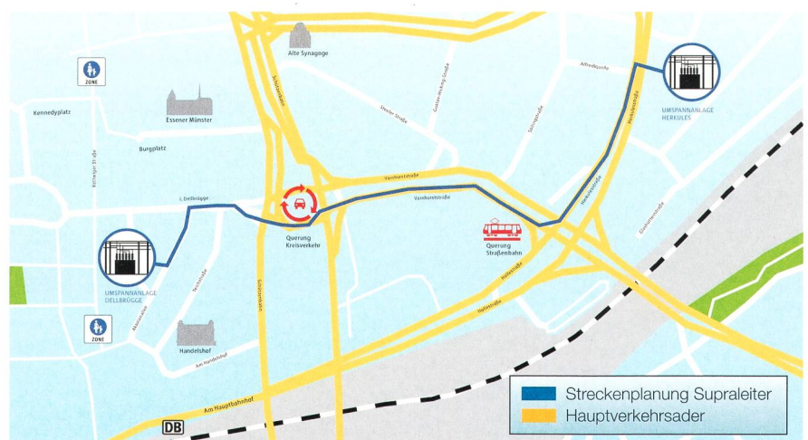
Bild 1 Trassenverlauf des supraleitenden Kabels in der Essener Innenstadt.
