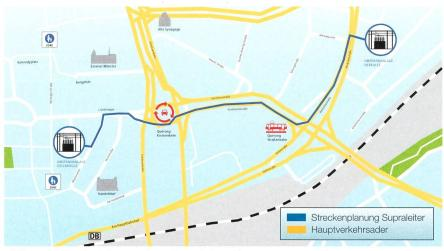
**Bild 1** Trassenverlauf des supraleitenden Kabels in der Essener Innenstadt.
