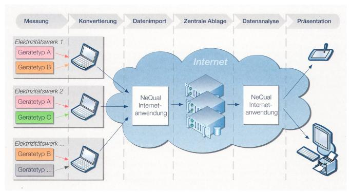
Bild 1 Prinzipieller Aufbau und Funktionsweise des Programmsystems NeQual.
