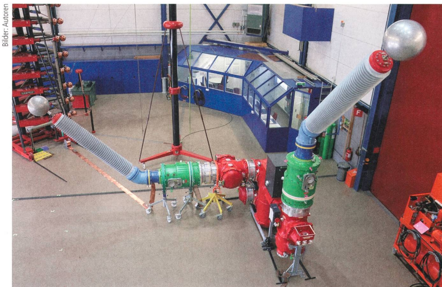
Bild 6 Dielektrische Typprüfung einer 145 kV-GIS-Schaltanlage im Hochspannungslabor in Oberentfelden.
