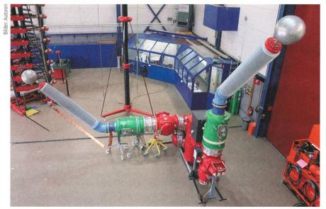
**Bild 6** Dielektrische Typprüfung einer 145 kV-GIS-Schaltanlage im Hochspannnungslabor in Oberentfelden.
