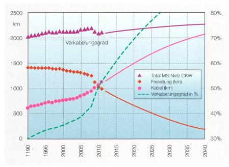
Bild 2 Entwicklung und Prognose 20-kV-Netz.
