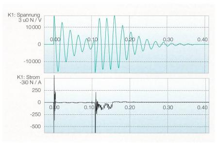
Bild 3 Nullspannung und Nullstrom während eines Fehlers.
