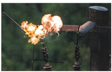
Bild 1 Im Probebetrieb wurden Lichtbögen provoziert.
