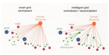
Bild 5 Intelligent Grid – netzfreundliche Selbststeuerung von kleinen Produzenten/Verbrauchern.
