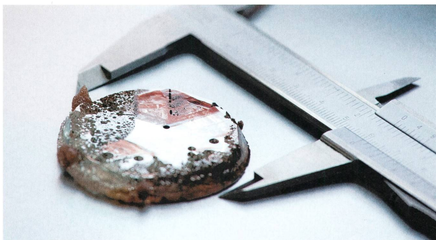
Kristallscheibe, die mit dem Verfahren der Hybrid-Gasphasenepitaxie hergestellt wurde.
