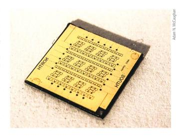
nTron-Addierer: quadratzentimeter grosser supraleitender Chip, mit dem gerechnet werden kann.
