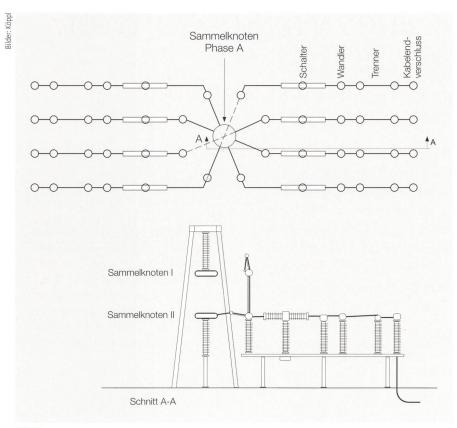
Bild 4 Doppel-Sammelknoten einer Phase mit 8 Abgängen in Freiluftausführung.
