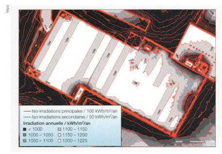
Figure 8 Courbes d'iso-irradiation annuelle sur la toiture principale.
