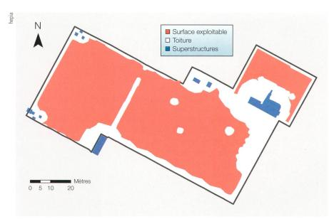
**Figure 10** Partie utile de la toiture commerciale issue de l'analyse de l'irradiation solaire (en rouge) et superstructures (en bleu).
