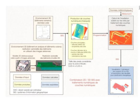
Figure 2 Vue synoptique de la démarche utilisée et des outils pour calculer l'irradiation solaire sur le territoire.
