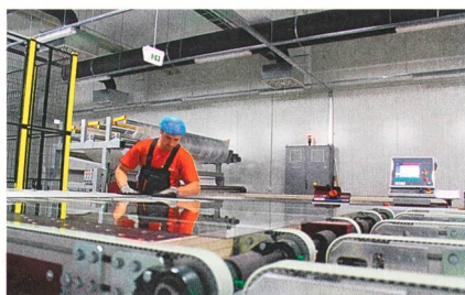
Projektspezifisches Schneiden der Folien.
