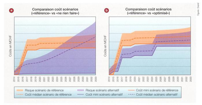
Figure 4 Comparaison du coût du risque (y compris coûts d'indisponibilité) des scénarii « ne rien faire » (à gauche) et « optimisé » (à droite) avec celui du scénario de référence.
