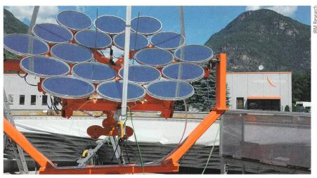
Ein Prototyp des Solarkonzentrators. Künftige Konzentratoren werden aus einer 40 m² grossen Parabolschüssel aus Spezialbeton mit ähnlichen mechanischen Eigenschaften wie Aluminium bestehen.
