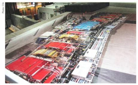
Finalement, une photographie à l'échelle des dispositifs situés tout au long de l'anneau de stockage a permis de se rendre compte de la complexité de l'installation. Ceux-ci sont destinés à contrôler les trajectoires des électrons et à extraire la lumière synchrotron (représentée à gauche par les points lumineux rouges) utilisée dans les stations dédiées aux expériences (en noir).
