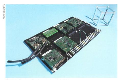
Figure 4 L'émulateur électrique « Flat Sat » de CubETH.
