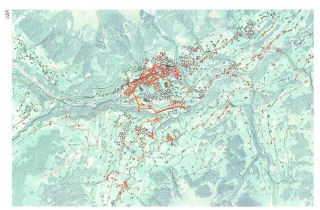
**Bild 2** Ausschnitt aus dem Adelbodner Netzplan. Das Glasfasernetz reicht bis in die entfernten Aussenhöfe und Weiler.
