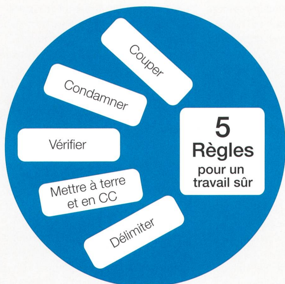
Figure 3 Règle des 5 doigts électrique.
