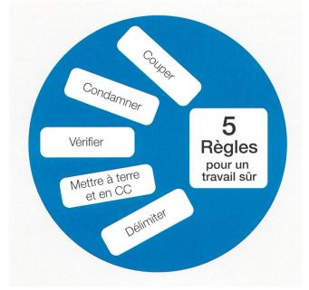
Figure 3 Règle des 5 doigts électrique.
