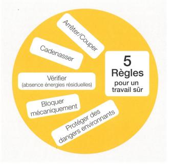
Figure 4 Règle des 5 doigts mécanique.
