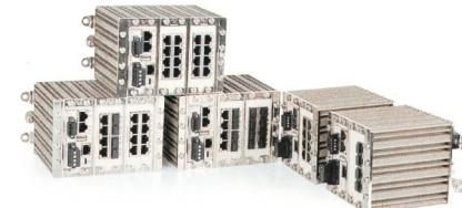
Als Layer-3-Routing-Gerät bietet der RedFox statisches und dynamisches Routing (OSPF).
