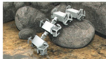
Der Centipede ist flach und kann durch Spalten kriechen, die für Menschen zu eng sind.
