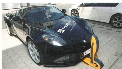
La nouvelle recharge par induction par le devant est efficace et peu coûteuse.
