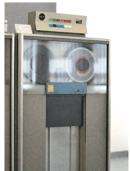
Die Magnetbandeinheit IBM 3420 6 speicherte 6250 bit pro Zoll. Damaliger Preis: 180 000 $.
