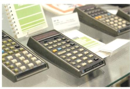
Eine Vitrine ist diversen Hewlett-Packard-Rechnern gewidmet. In der Mitte ist das 1975 eingeführte Modell 55 sichtbar, ein programmierbarer Taschenrechner mit Stoppuhrfunktion.
